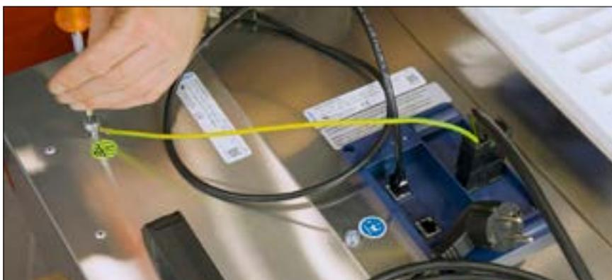
Das Erdungskabel der Stromleitung **2** muss fest mit der Erdungsschraube der FFU verbunden werden
